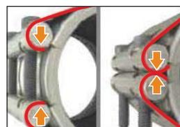
Apertar o parafuso, até a caixa ficar em contacto com o metal.
